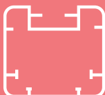
SECCIÓN Ø 80 x 80 mm ALUMINIO
